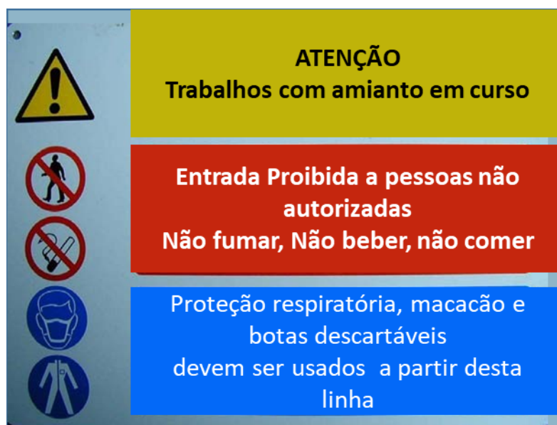
Figura 9. Sinais de aviso relativos a perigos e a precauções a tomar, recorrendo a símbolos e palavras
